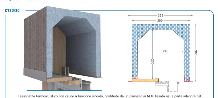
Cassonetto termoacustico con doppio celino a tampone singolo, costituito da un pannello in MDF fissato nella parte inferiore
